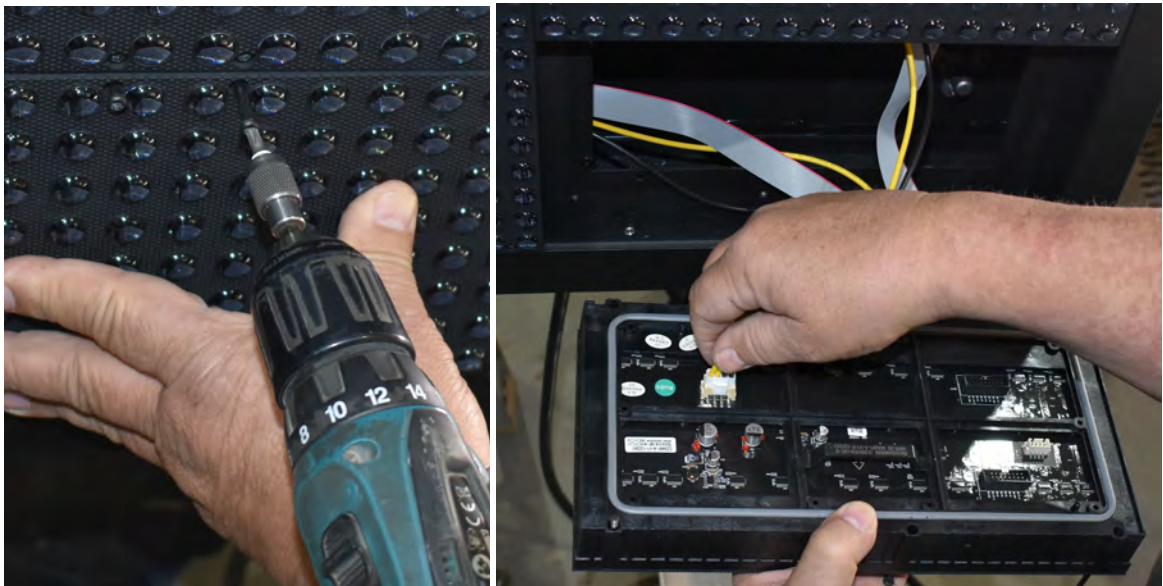
Bild 37-38. Skruva loss den trasiga tilen (Torx 20) respektive kontaktering av kraftkabeln, kontakten dras ut när den dekontakteras respektive sticks in vid kontaktering.
