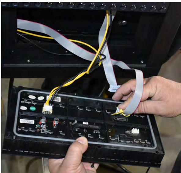
Bild 39-40. Kontaktering av flatkabel. De sticks in men för att ta ut dem måste först snäplåsningarna på sidorna vridas utåt.
