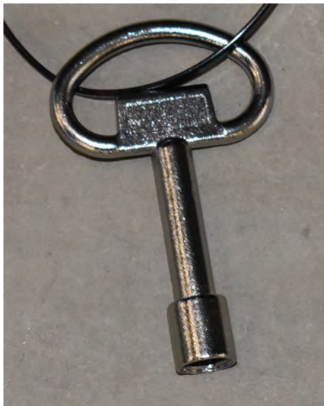
Bild 28-29. X5-tavlan öppnas genom att låsningarna låses upp med elskåpsnyckel (dvs. fyrkantsnyckel, artikelnummer: 20028, medföljer vid leverans, alternativt kan ¼ tum hylsa användas).
