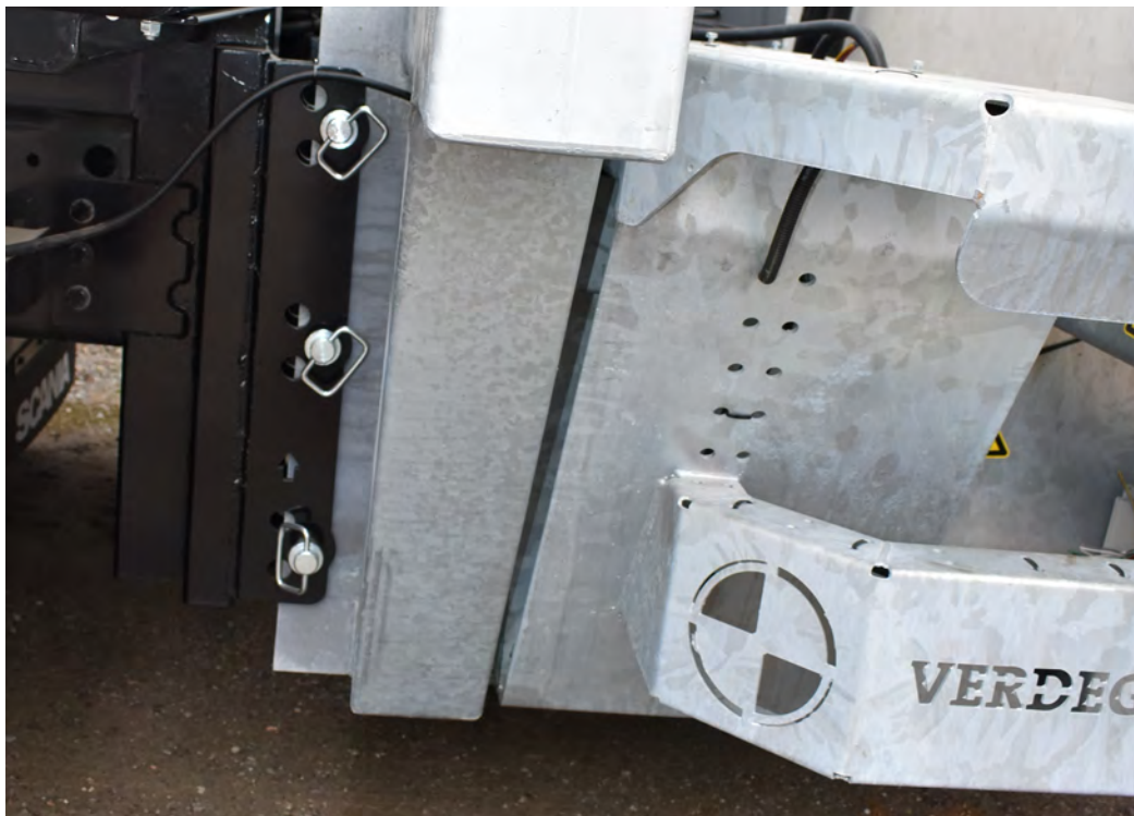
Bild 4. En Victory fäst i hjälpramen på ett adekvat sätt med sex bultar som skall låsas med saxsprintar.
