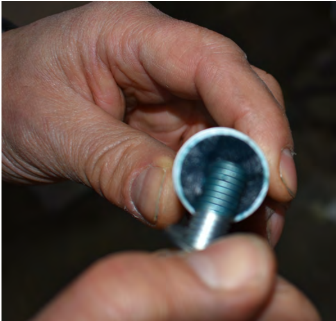
Bild 9. En av de 12 skruvarna smörjs in med blå Loctite.
