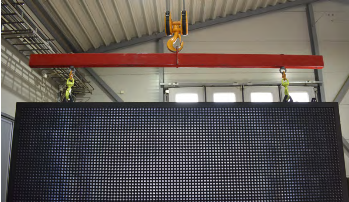
Bild 7. MaxiSign Online hängandes, via lyftkrokar, i en traverskran.
