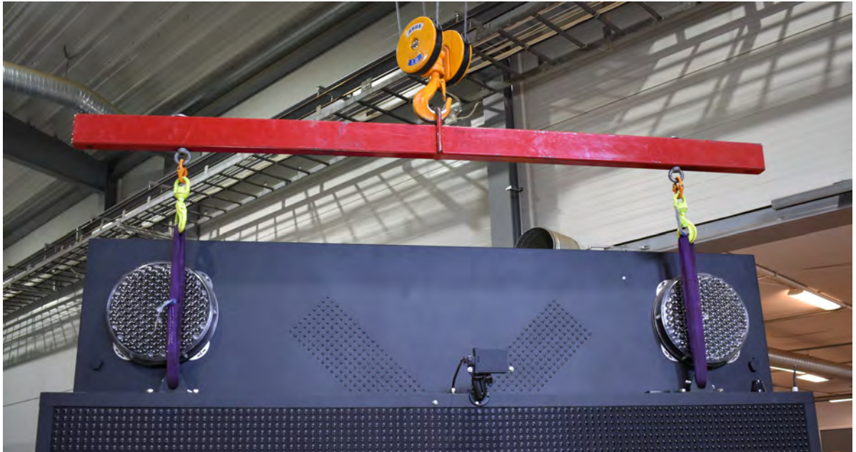
Bild 3. MaxiSign Online med X5 hängandes via sling i en travers.
