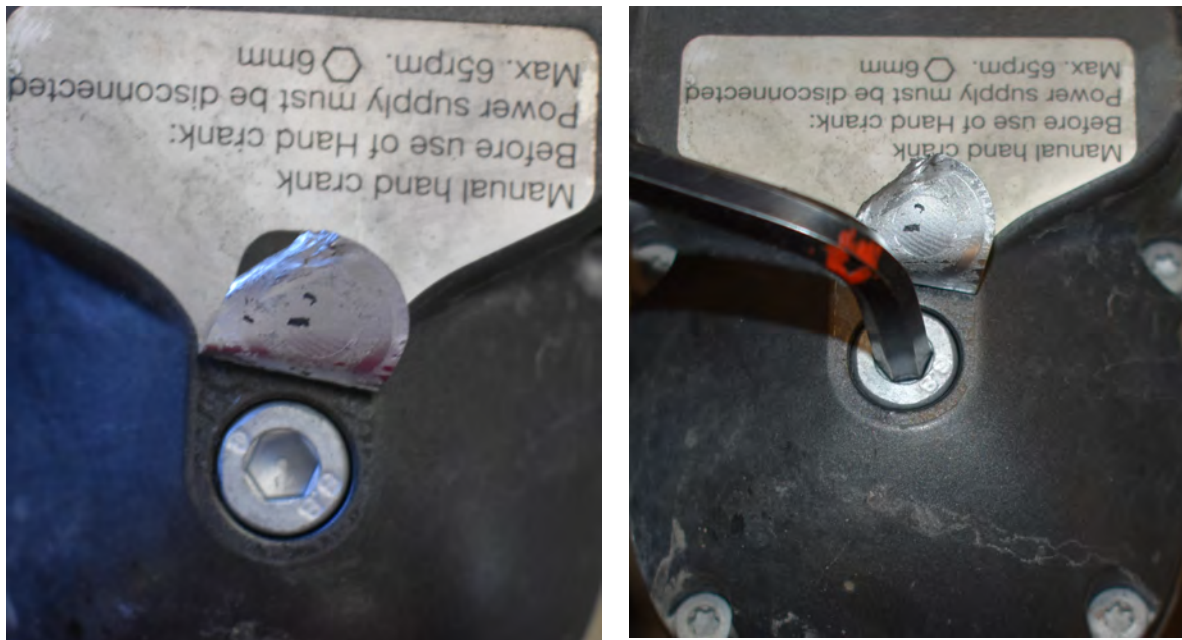
Bild 33-34. Nödmanövreringen av linjärrörelsen är dold bakom klistermärket/dekalen. Respektive: Ta bort tätningssluggen genom att skruva ur den med en 6 mm insexnyckeln.
