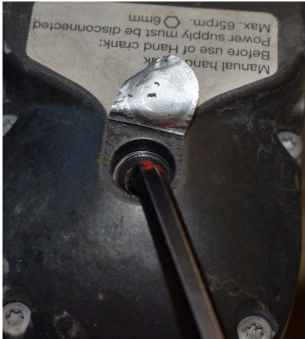
Bild 35. Vrid med insexnyckeln för att sänka X5-tavlan.
