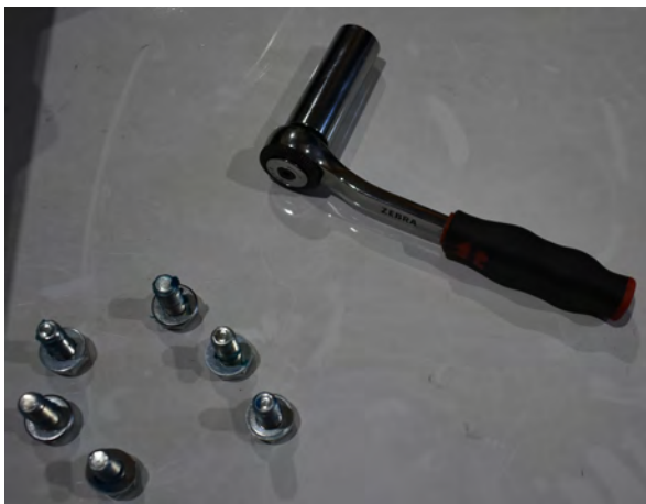
Bild 8. De sex M6-skruvarna med spärrskaft och hylsa 10.
