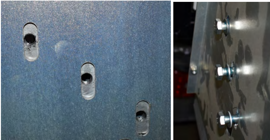
Bild 15-16. Skruvhålen utan respektive med skruv i en av de fyra fästplåtarna. Notera att det är blå Loctite på skruvarna.
