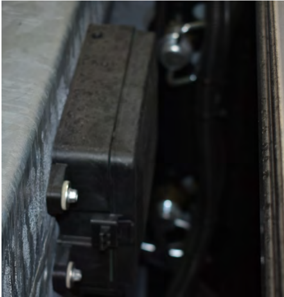
Bild 19. Säkringsbox (artikelnummer: 10811), för två säkringar monterad på Victory.
