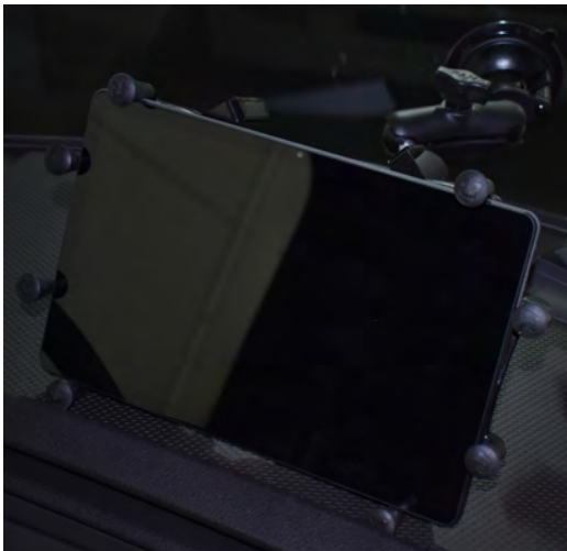
Bild 22. Surfplattan monterad i fästet som i sin tur är monterat på vindrutan.
