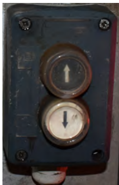
Bild 36. Knappsats för höjning/sänkning av TMA-skyddet, den är monterad på vänster sida av skyddets stativ.
